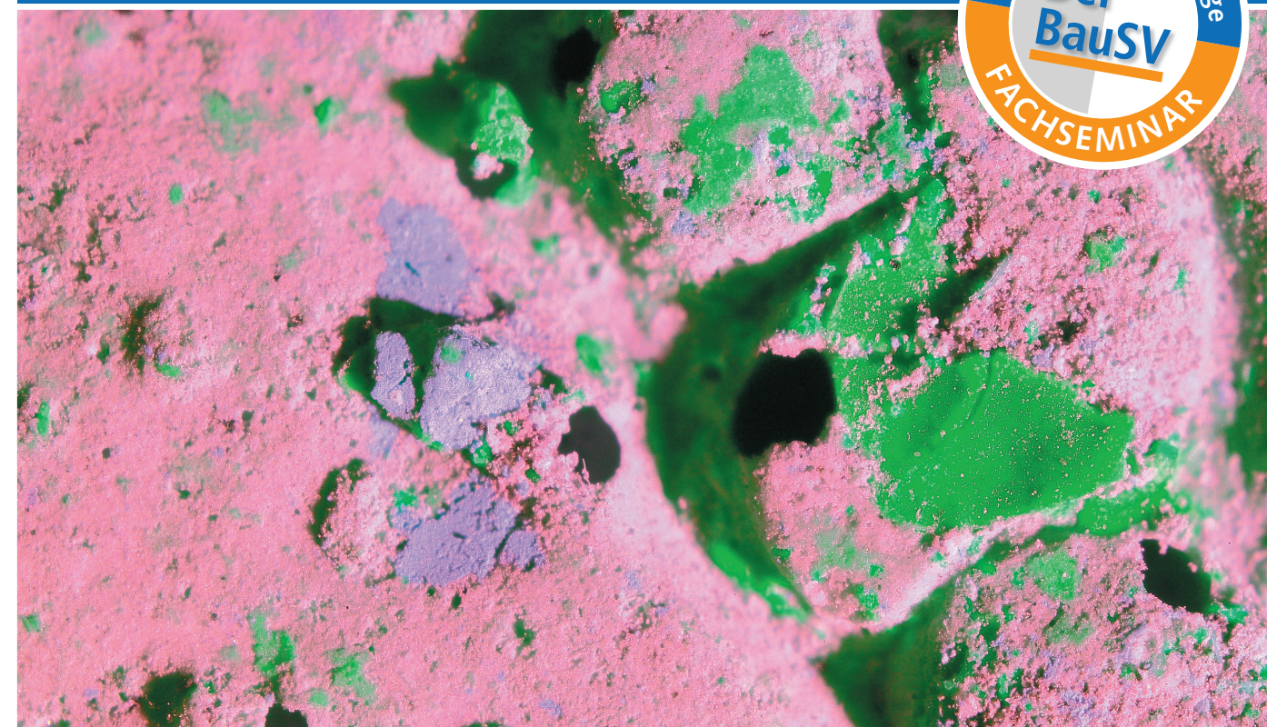
Bruch in einem Renovierungsaufbau aus mineralischem Altuntergrund (violett), Grundierung (grün) und zementärer Spachtelmasse (rosa). Ohne bauforensische Hilfsmittel sieht alles einheitlich grau aus und es sind keine unterschiedlichen Materialien und kein Schichtenaufbau erkennbar. (© Rapp)
